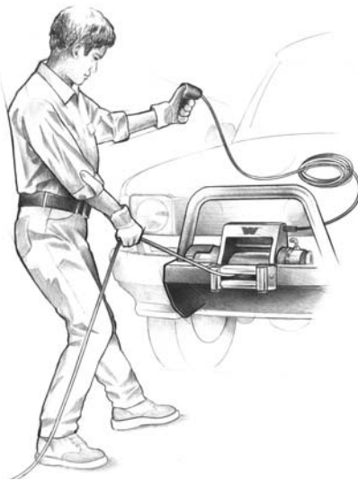
Etapa 18: REBOBINAR O CABO DE AÇO. A pessoa que estiver manipulando o cabo de aço deve passar o cabo e não deixar que ele deslize através das mãos e deve também controlar o guincho sempre.
